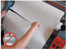
Stoppez la marche avant lorsque le support atteint la limite des rouleaux (l'adhésif ne doit pas coller sur le rouleau inférieur).
